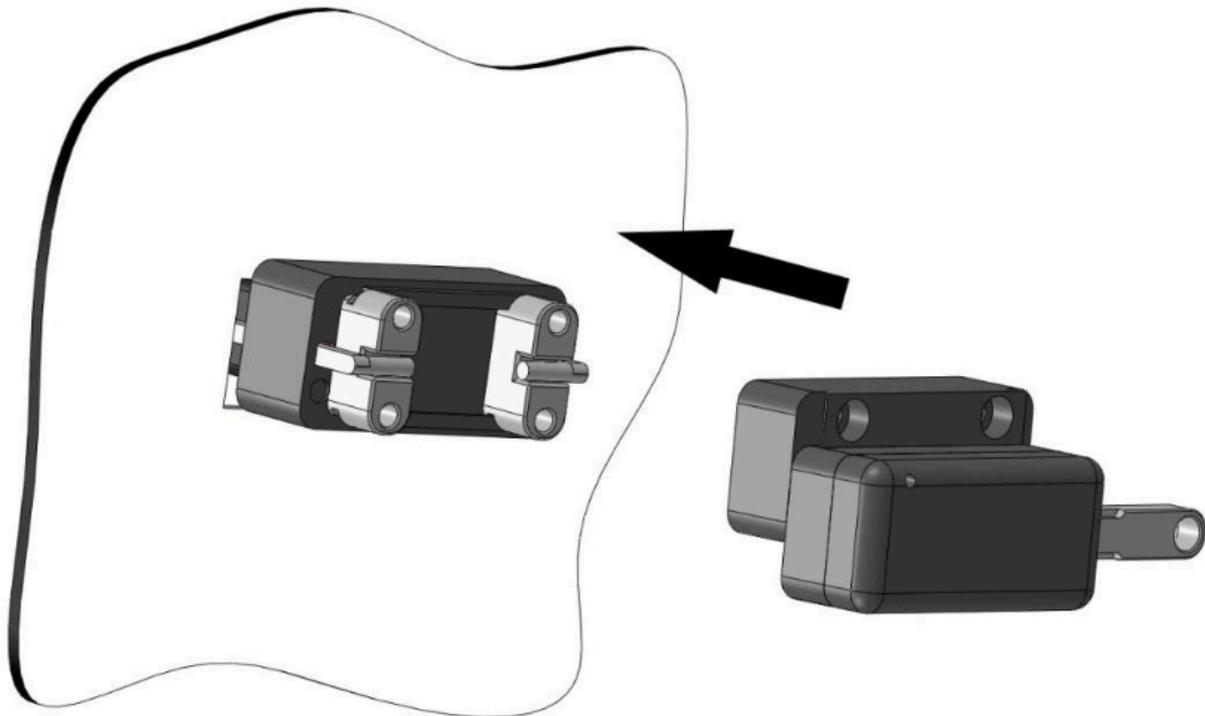
Inbusschrauben (2x) M3 montieren und mit Inbusschlüssel handfest andrehen.
