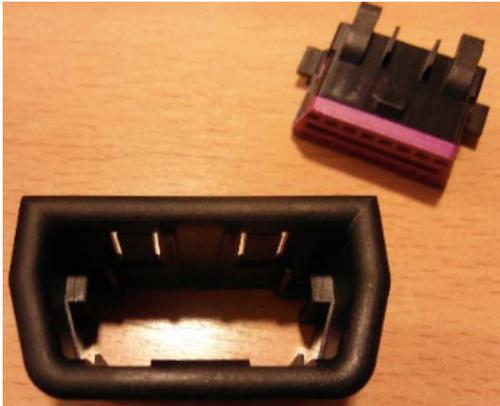
OBD-Buchse aus Halterahmen demontiert
