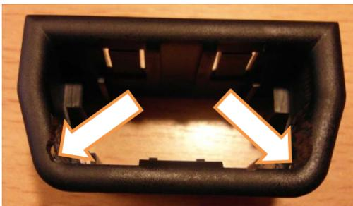
Die Ecken des Halters müssen ein wenig frei gemacht werden damit das Gehäuse vom OBD- Saver aufgesteckt werden kann. Ein Multirotationswerkzeug (Dremel) eignet sich perfekt für die Bearbeitung.
