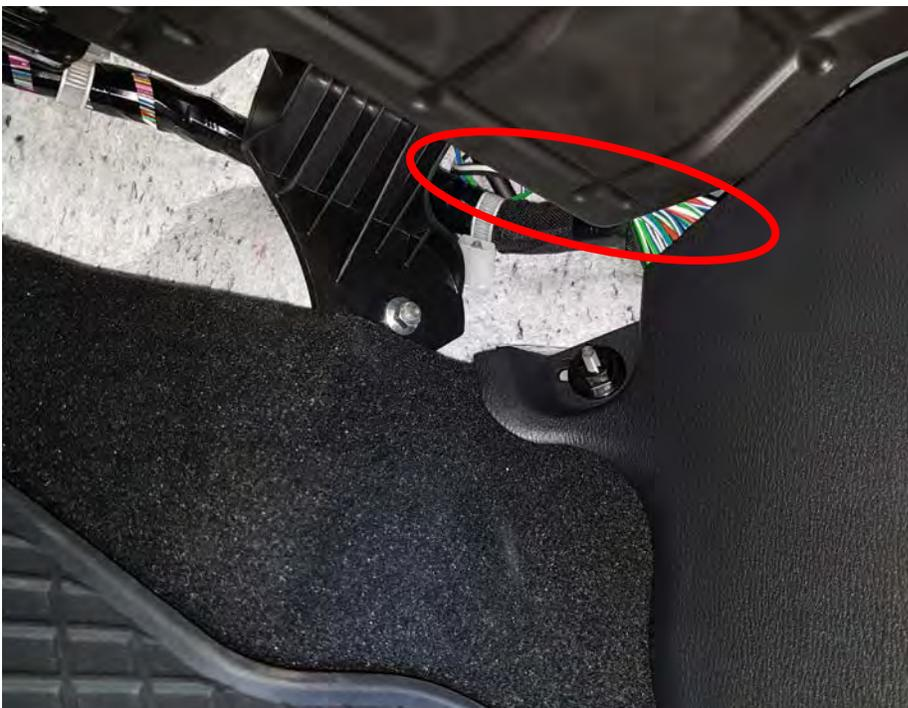
Das Rückfahrsignal (wie später unter 3.3 gezeigt) am RBCM abgreifen, Kabel vom RBCM in den Fahrerfußraum verlegen und mit dem Kabel am Bordsteinautomatik-Modul verbinden.
