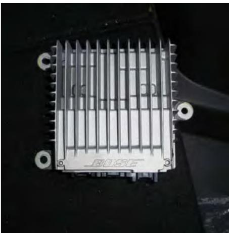
Den Verstärker ausbauen und danach noch seine Halterung wegschrauben damit man Zugriff auf den Beifahrertür-Stecker hat – ggf. kann man wie beim FL das Kabel zum Stecker nutzen und muss gar nicht an den Stecker gehen.
