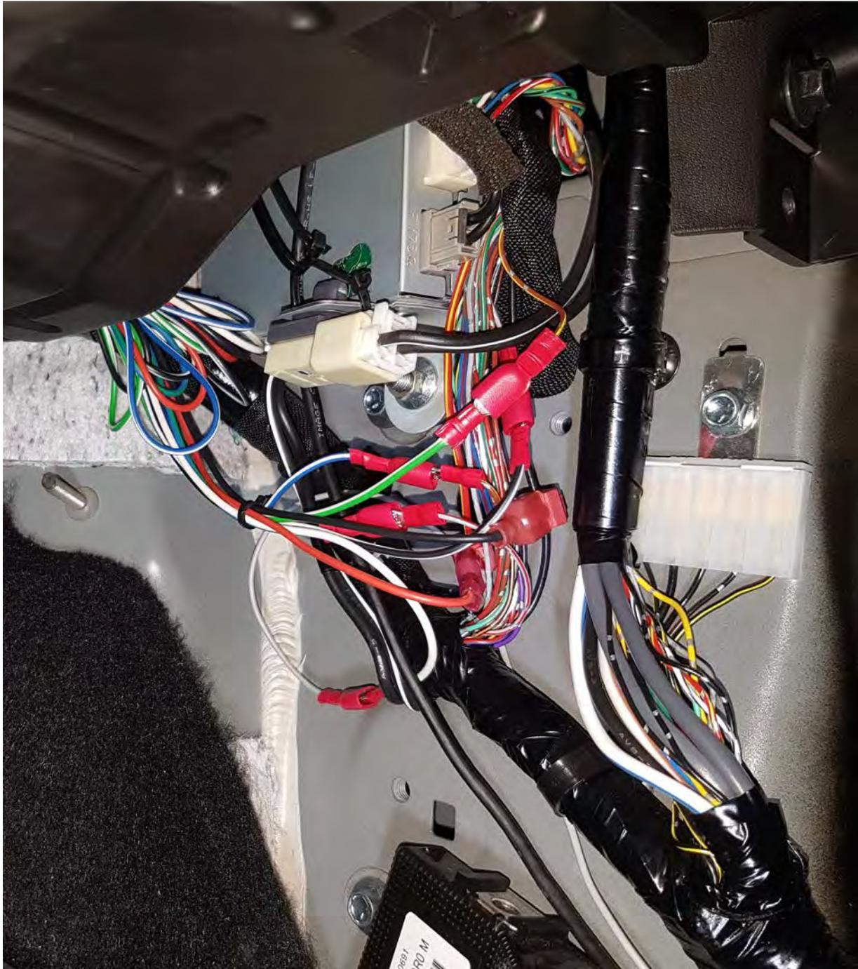
Modul eingeklemmt & oben mit Kabelbindern fixiert // Kabelbinder fixieren Kabel & Modul:
