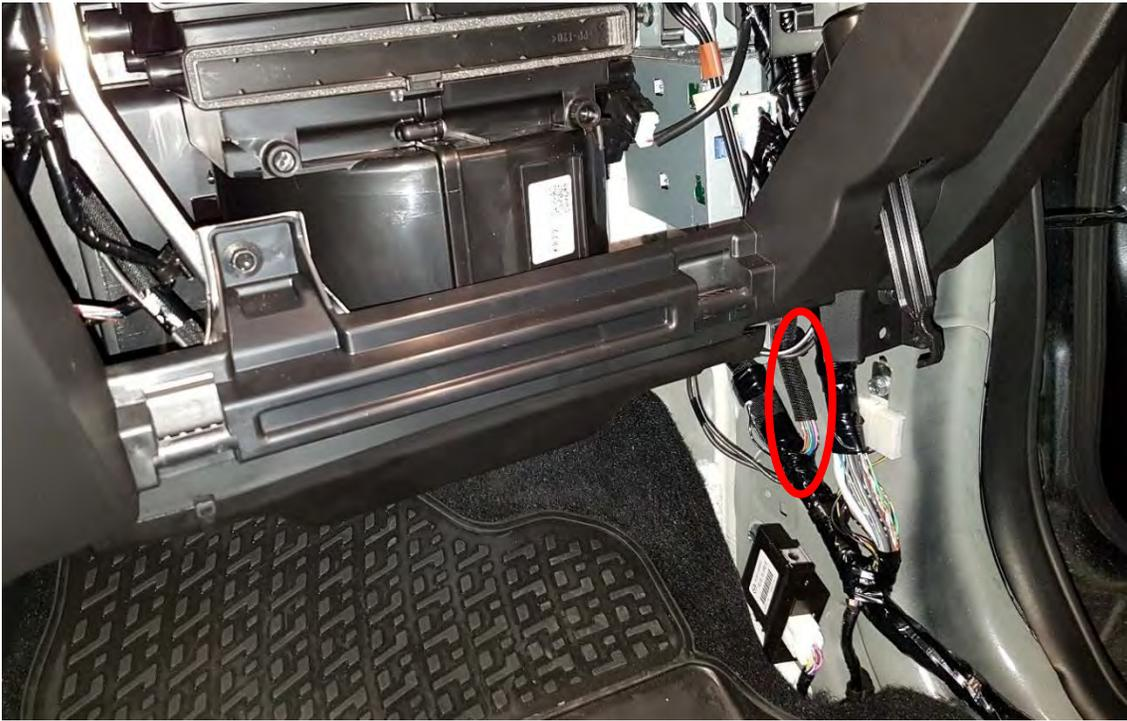
Möglicher Einbauort für das Bordsteinautomatik-Modul (z.B. mit Kabelbindern befestigen):
